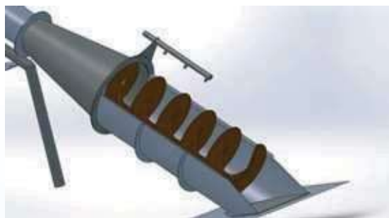
СИСТЕМА ПРОМЫВКИ ЗАГРУЗОЧНОЙ КОРЗИНЫ
